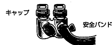
キャップ 安全バンド 使用しないガス栓はキャップをする Put a plug on a gas valve being unused.
